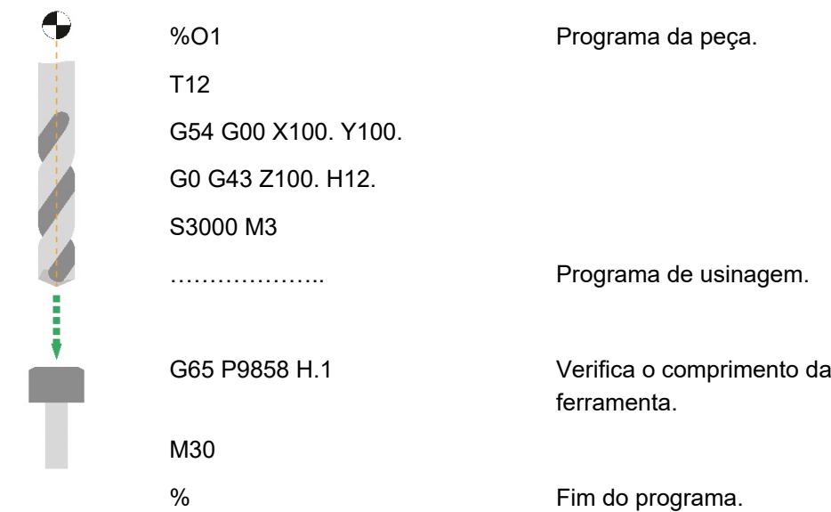
Figura 6.2 Verificação de uma broca
